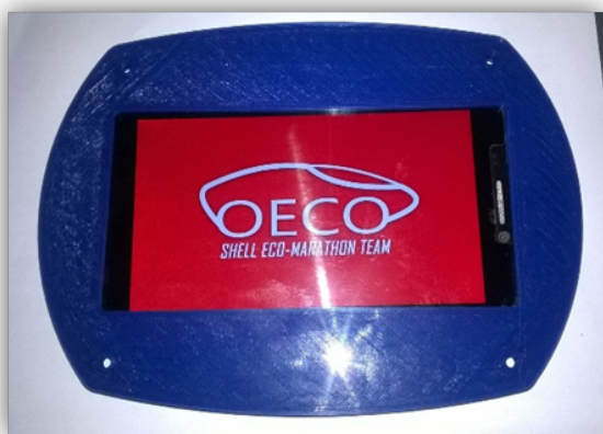
3. ábra: 3D nyomtatással készült kormányközép, beépített okostelefonnal
